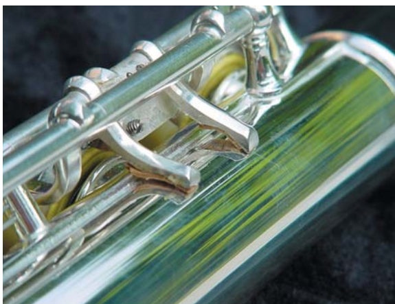
Der Anschlag der D-Klappe ist falsch geformt
