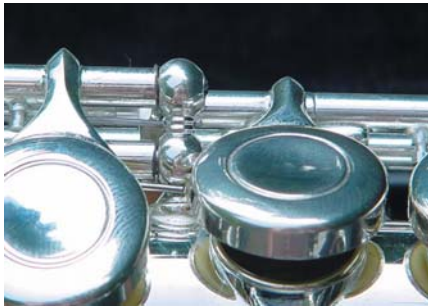
Die Achsröhrchen wurden zu kurz bzw. schief abgeschnitten und nicht entgratet
